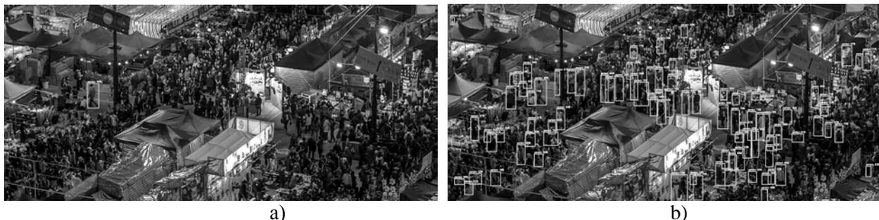
Рисунок 5 – Результаты обнаружения: а) на основе СНС YOLOv4; б) на основе рассмотренной методики
