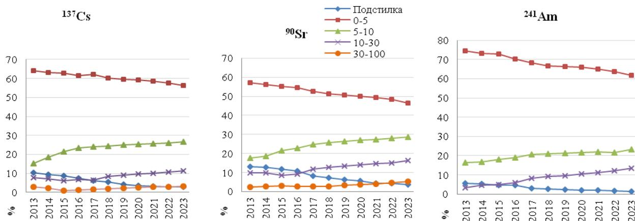
Рисунок 3 – Динамика вертикального распределения радионуклидов  $^{137}\text{Cs}$ ,  $^{90}\text{Sr}$ ,  $^{241}\text{Am}$  в профиле почвы на площадке дубового леса Ф-3
