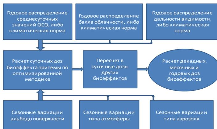
Рисунок 1 – Блок-схема алгоритма численного моделирования доз биоэффектов приземного солнечного УФ излучения
