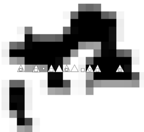
Рисунок 2 – Детальное изображение постоянного шага \Delta x = 2 при распознавании изображения
