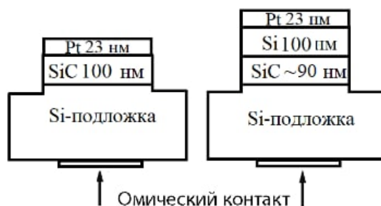
Рисунок 1 – Мезоструктуры образцов использованных для измерения ВАХ
