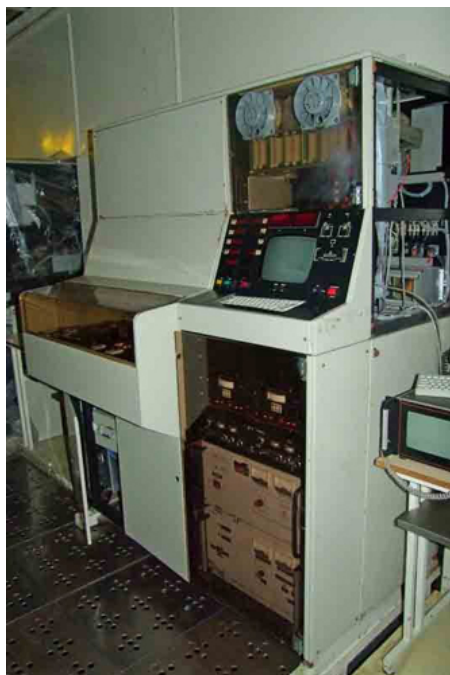
Рисунок 2 – Установка реактивно-ионного травления GIR 260S
