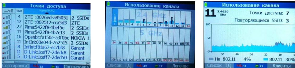
Рисунок 5 – Экраны работы Fluke AirCheck
